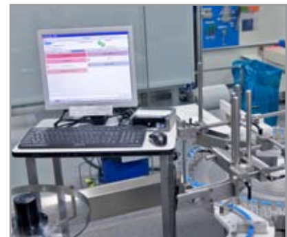
Computergestützter Arbeitsplatz mit MDE-Eingabemaske an einer Anlage zur Abfüllung von Vials.
