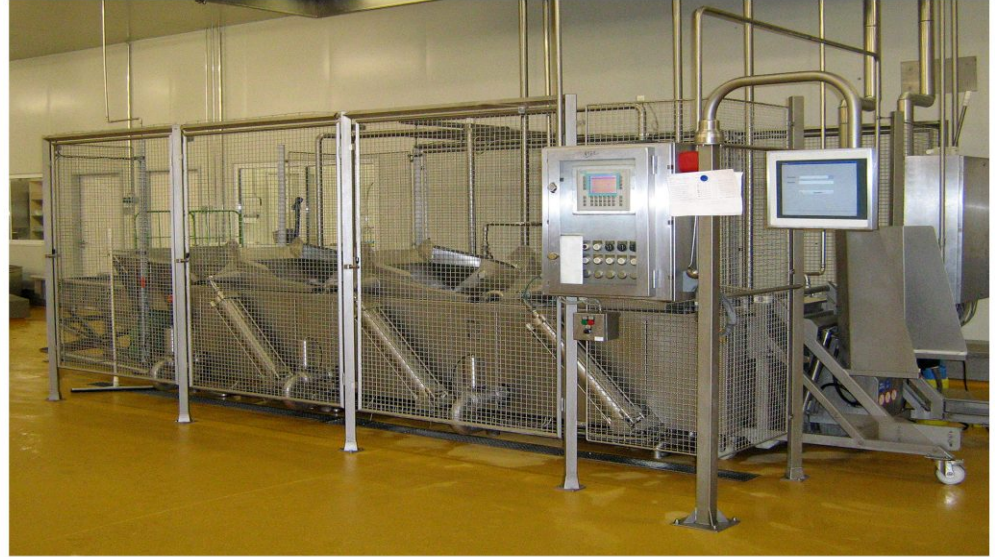
Der IT-gestützte Maschinenpark im Werk III umfasst derzeit zwei Kippkochkessel, zwei Dispergierkessel (links) sowie mehrere hintereinander geschaltete Hochdruckdampf-kochkessel (rechts)
