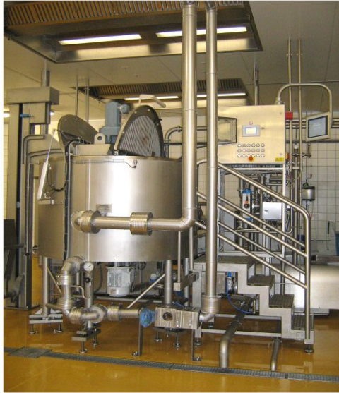
Der IT-gestützte Maschinenpark im Werk III umfasst derzeit zwei Kippkochkessel, zwei Dispergierkessel (links) sowie mehrere hintereinander geschaltete Hochdruckdampf-kochkessel (rechts)
